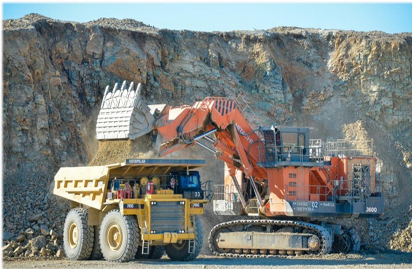
НІТАСНІ-3600 ЭКСКАВАТОРЫ САТЕРПІЛЛАР 785С АВТОСАМОСВАЛЫНА КЕН ТІЕУ ҮСТІНДЕ
