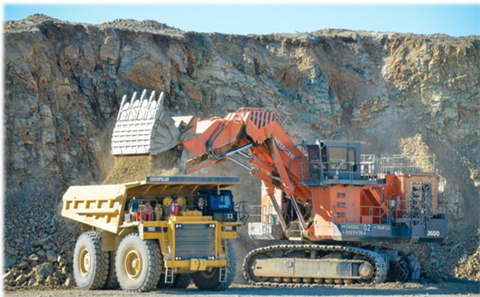
4 Сурет – Hitachi-3600 экскаваторы Caterpillar 785C автосамосвалына кен тиеу үстінде
